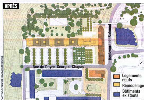
L'opération de remodelage consiste à écrêter la barre 320, à construire sur son toit, à l'épaissir côté est et à lui adjoindre des extensions (logements neufs).
